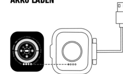
Legen Sie die Smartwatch in die Ladestation und richten Sie sie auf die 4 Kontakte aus. Schließen Sie das andere Ende zum Laden an den Standard-USB-Anschluss an.
