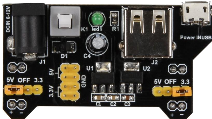
Dieses Modul erlaubt Ihnen die einfache Spannungsversorgung Ihrer eigenen Experimente oder Versuchsaufbauten auf Breadboards. Die Platine wird einfach aufgesteckt und versorgt dann das Breadboard mit 3,3 und 5V. Die Spannung ist für jede Seite einzeln einstellbar.
