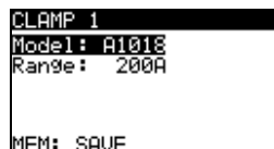
Abbildung 4.17: Konfigurierung der Stromzangen-Messeingänge
