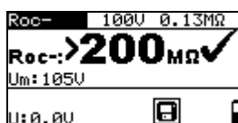
Abbildung 6.3: Beispiele für Ergebnisse von Isolierungswiderstandsmessungen
