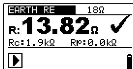
Abbildung 5.35: Beispiel des Ergebnisses einer Erdungswiderstandsmessung
