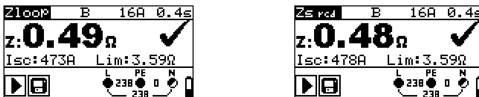
Abbildung C.3: Beispiele für das Ergebnis einer Schleifenimpedanzmessung
