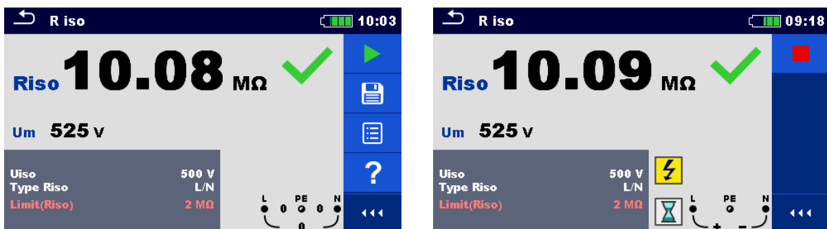
Abbildung 6.1: Aufbau Einzelprüfungs-Bildschirm, beispielsweise von der Isolationswiderstandsmessung
