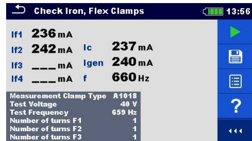
Abbildung 11.104: Beispiel Stromzangen, Flexible Stromzangen Prüfung Ergebnis
