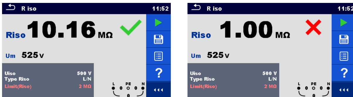
Abbildung 6.33: Beispiele für Ergebnisse der Isolationswiderstandsmessung (Installation)
