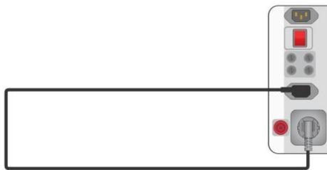
Abbildung 6.22: Kompensation zwischen Netzprüfsteckdose und IEC Steckdose
