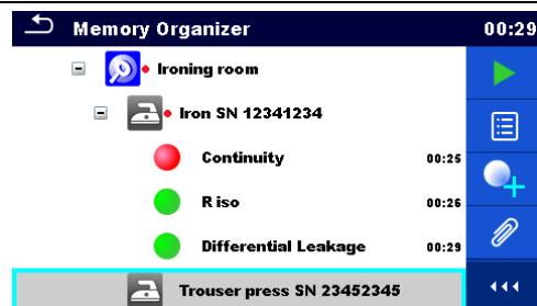
Abbildung 5.5: Status – Messungen abgeschlossen mit Ergebnis durchgefallen
