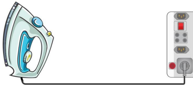
Abbildung 6.26: Isolationswiderstand Riso (Prüfsteckdose)
