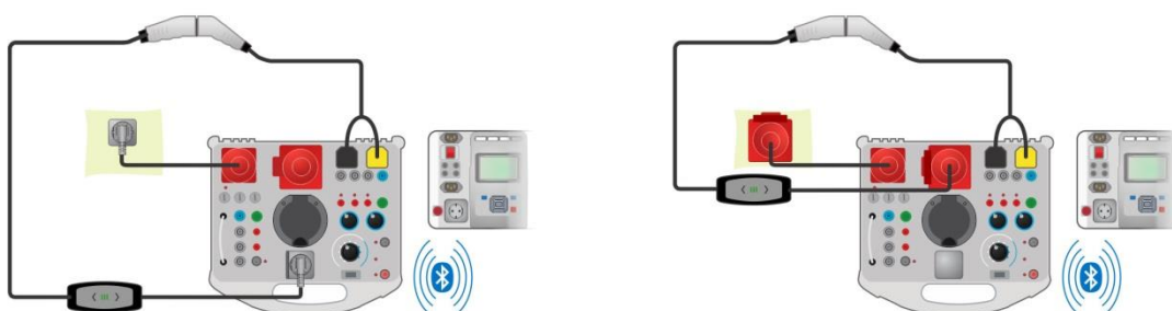
Abbildung 6.105: Diagnostischer Test - EV-Simulator und Fehler Teilprüfungen - Verbindung mit Mode 2 Ladekabel mit Leistungszufuhr vom Analyser
