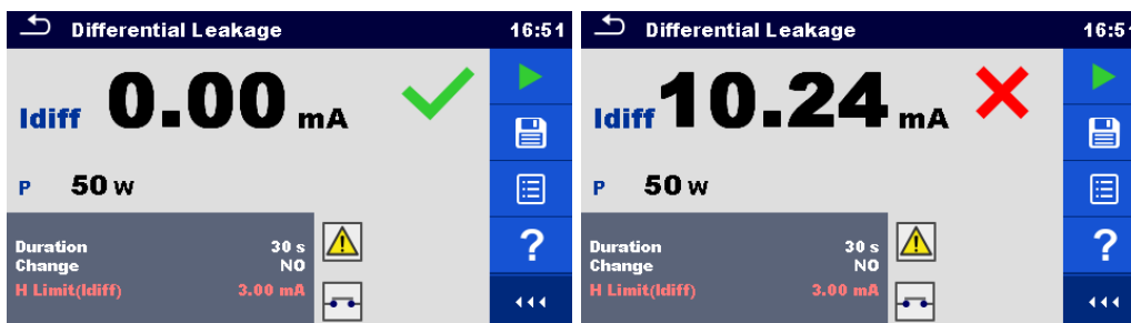
Abbildung 6.40: Beispiele für Ergebnisse der Differenzableitstrom Messung
