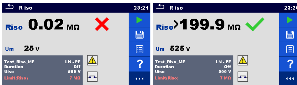
Abbildung 6.89: Beispiele für Ergebnisse der Isolationswiderstandsmessung (med. Geräte)
