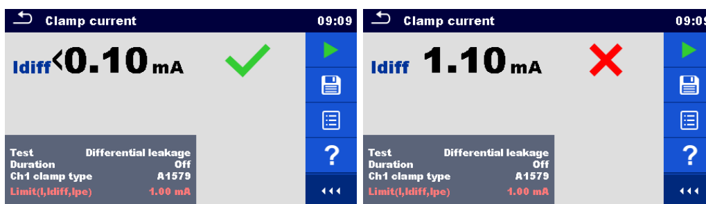
Abbildung 6.75: Beispiele für Ergebnisse der Zangenstrom Messung
