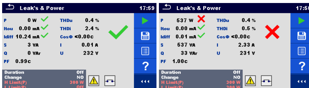
Abbildung 6.52: Beispiele für Ergebnisse Ableitstrom- und Leistungsmessung
