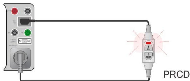
Abbildung 6.63: Prüfung (PRCD) Leitungsunterbrechung
