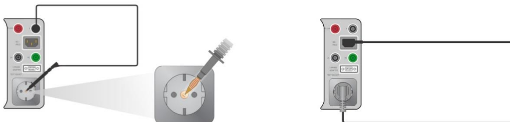
Abbildung 6.21: Kurzgeschlossene Prüflleitung / IEC Prüflleitung
