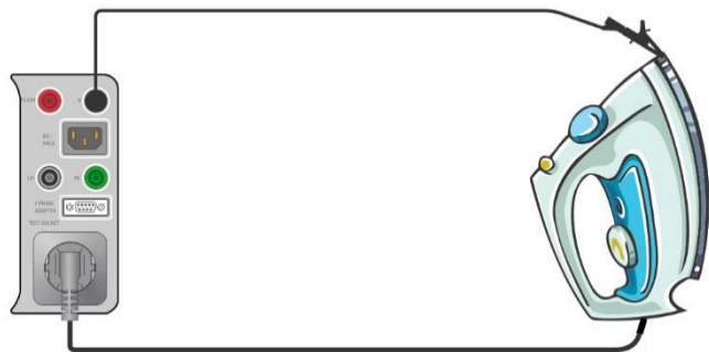
Abbildung 6.17: Schutzleiterwiderstand Steckdose – IEC
