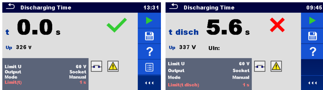
Abbildung 6.66: Beispiele für Ergebnisse der Entladezeitmessung (Anschluss = Prüfsteckdose)
