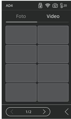
**Kamera:** Entfernte Überwachung. Einschalten der Kamera während des Drucks und Einschalten des Zeitraffers. Das Zeitraffervideo kann auf dem Wechseldatenträger gespeichert werden. Wählen Sie dazu [Bild] > [Foto]. Die Live-Szene wird in einer Bildabfolge gespeichert.
