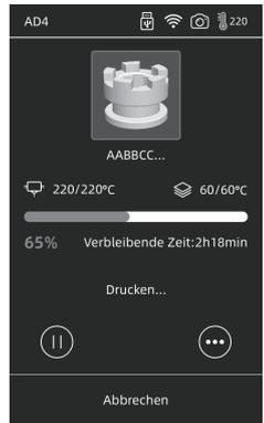
Importieren Sie die stl- oder obj-Datei in den Slicer. Nach dem Slicen erfolgt der Aufwärmvorgang. Dann startet der Druckvorgang automatisch.
