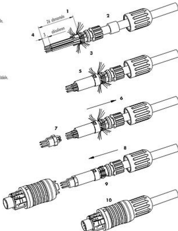
Bezeichnung **Push-Pull Kabeldose, Polzahl: 8, 3,5 - 5,0 mm, schirmbar, löten, IP67**
