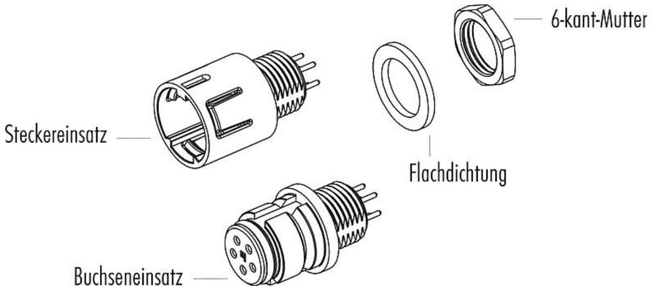
Bezeichnung Snap-In IP67 Flanschstecker, Polzahl: 5, ungeschirmt, tauchlöten, IP67
