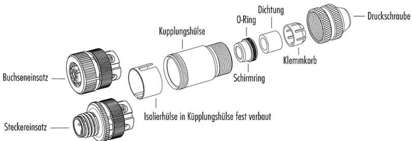
Bezeichnung **M12-B Kabdose, Polzahl: 5, 8,0 - 10,0 mm, schirmbar, schraubklemm, IP67, UL**
