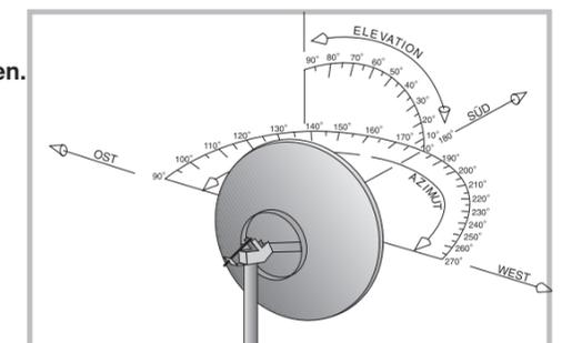
Das Prinzip von Azimut und Elevation bei der Ausrichtung einer Satellitenantenne
