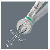
Durch die um 7,5° geschwenkte Maulseite, Doppelsechskantgeometrie und eine angepasste Anwendungsweise (Ansetzen -Schrauben - Drehen - erneut Ansetzen - Schrauben - Drehen usw.) können auch Schraubsituationen gelöst werden, die weniger als Schwenkwinkel zulassen.
