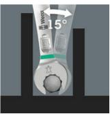
Der Ringmaulschlüssel Joker 6003 seiner besonderen Maulgeometrie - eine um 7,5° geschwenkte Maulseite und die Doppelsechskantgeometrie verdoppelt die Ansetzmöglichkeiten bei wiederholter 180°-Drehung des Schlüssels um die Längsachse. Muttern bzw. Schraubenköpfe können 15° "gepackt" alle Den jeweiligen werden. Ansetzpunkt findet der Joker 6003 nach jedem Wenden sozusagen von selbst.
