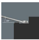
Die Ringseite ist um 15° zur Werkzeugachse abgewinkelt, um Verletzungen vorzubeugen.
