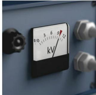
Die Prüfung des Werkzeugs auf Durchschlagsfestigkeit bei 10.000 Volt gibt dem Anwender die beruhigende Gewissheit, dass sein Schraubendreher auf seine wichtigste Eigenschaft, die Isolation, geprüft worden ist. Wera VDE-Schraubendreher werden Stück für Stück dieser Prüfung unterzogen. Sichereres Arbeiten bis 1.000 Volt ist somit garantiert.
