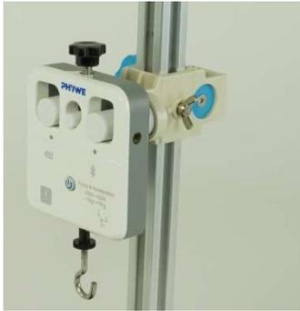
Abb. 14 Höhenversteller mit Flügelschraube
