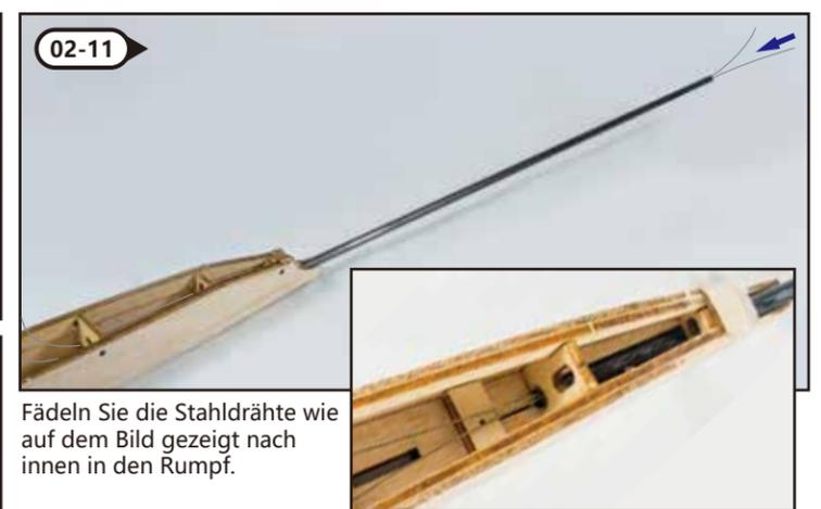
Fädeln Sie die Stahldrähte wie auf dem Bild gezeigt nach innen in den Rumpf.
