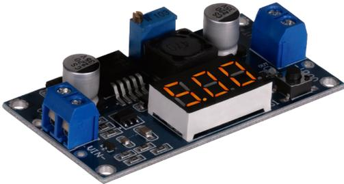
Dies ist ein Spannungswandler der auf dem DC-DC Modul LM2596S basiert. Die Spannung kann mit Hilfe des Potentiometers mit einer Genauigkeit von  $\pm 0.1$  V justiert werden. Über den Knopf kann die integrierte Segmentanzeige zusätzlich zwischen der Eingangs- und der Ausgangsspannung umgeschaltet werden.
