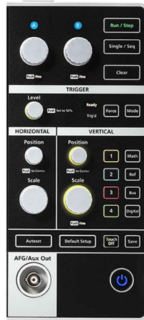
Vereinfachte und intuitive Frontplatte mit farbkodierten LEDs
