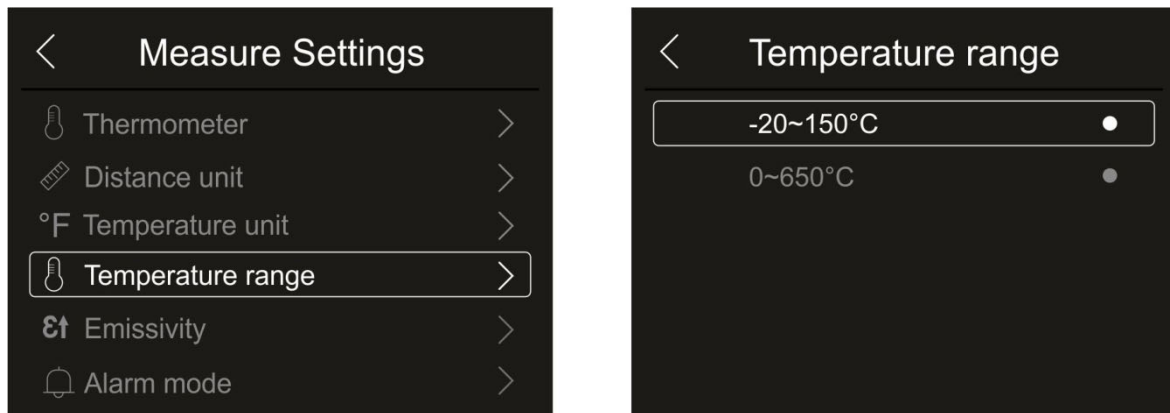
Abb. 24: Menü Einstellung des Temperaturbereiches
