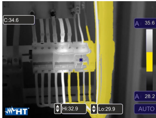
Abb. 39: Auswahl Isothermen-Linie Alarm Temp.-Intervall
