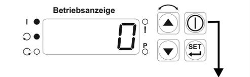
Wenn der Start/Stop Knopf gedrückt wird, erscheint der eingestellte Wert das Start LED leuchtet, der gewählte digitale Ausgang ist jetzt aktiv und das analoge Ausgangssignal beginnt vom Mindestwert langsam zum eingestellten Sollwert in einer Tauf(sek) Zeit des Anstiegs.
