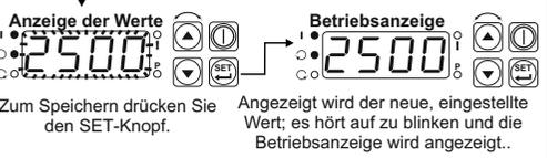
Wenn der eingestellte Wert verändert wird, während der Motor läuft, wird auch gleichzeitig das den Motor steuernde Ausgangssignal entsprechend verändert. Der Ausgang nimmt den neuen Wert an und rdbt und rdbt werden angezeigt.
