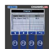
Verwenden Sie die Tasten F1 und F2, um den Wert des Parameters zu ändern.
