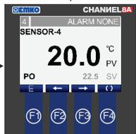
Wenn mehr als eine Alarmmeldung vorhanden ist, wird jede Alarmmeldung 1 Sekunde lang auf dem LCD-Bildschirm angezeigt.
