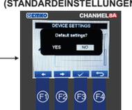
Gehen Sie mit der Taste F1 auf die Registerkarte „JA“ und drücken Sie die Taste F3. Nach 1-3 Sekunden wird das Gerät auf die Werkseinstellungen zurückgesetzt.
