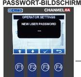
Drücken Sie die Taste F3. Wenn das Passwort ungleich 0 ist, wird der Passwort-Bildschirm geöffnet.
