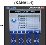
Drücken Sie die Tasten F1 und F2, um den Kanal zu markieren, und drücken Sie die Taste F3.
