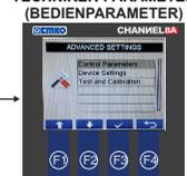
Blättern Sie mit den Tasten F1 und F2 zu den Bedienerparametern und drücken Sie die Taste F3.
