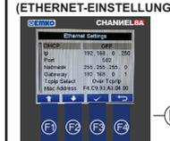
Mit den Tasten F1 und F2 können Sie die ETHERNET-Parameter auswählen und ändern. Verwenden Sie die Taste F3 zum Speichern.
