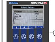
Mit den Tasten F1 und F2 können Sie die RS485-Parameter auswählen und ändern. Verwenden Sie die Taste F3 zum Speichern.
