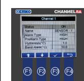
Verwenden Sie die Tasten F1 und F2, um den Wert des Parameters zu ändern. Drücken Sie die Taste F3, um den Parameter zu speichern.
