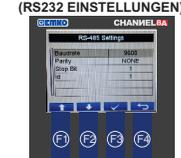
Mit den Tasten F1 und F2 können Sie die RS232-Parameter auswählen und ändern. Verwenden Sie die Taste F3 zum Speichern.
