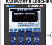
Drücken Sie die Taste F3. Wenn das Passwort ungleich 0 ist, wird der Passwort-Bildschirm geöffnet.
