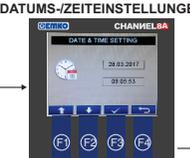
Mit der Taste F3 können Sie die Parameter Datum und Uhrzeit auswählen und mit den Tasten F1, F2 können Sie den Wert ändern.
