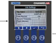
Mit den Tasten F1 und F2 können Sie die USB-Parameter auswählen und ändern. Verwenden Sie die Taste F3 zum Speichern.
