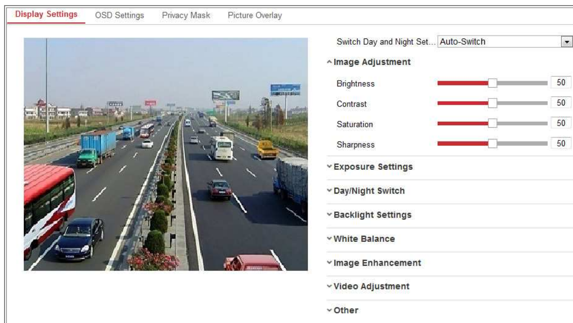
Abbildung 9–1 Anzeigeeinstellungen automatische Tag-/Nachtumschaltung
