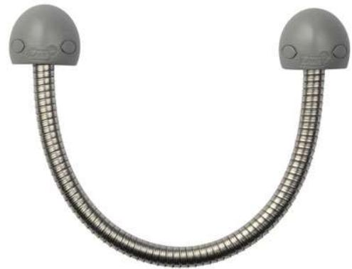
Die Kabelübergänge von CDVI bieten eine sichere Methode für die Kabelverbindung zwischen einem festen und einem beweglichen Punkt (z.B. Türrahmen und Türblatt). Das Kabel wird durch den Spiralschlauch aus Edelstahl geschützt. Der Innendurchmesser des Spiralschlauchs beträgt 7mm und ist somit für die gängigsten Kabel für Türverriegelungen und -steuerungen geeignet.
