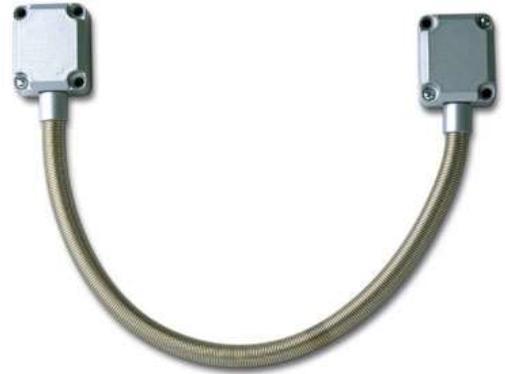
Die Kabelübergänge von CDVI bieten eine sichere Methode für die Kabelverbindung zwischen einem festen und einem beweglichen Punkt (z.B. Türrahmen und Türblatt). Das Kabel wird durch den Spiralschlauch aus Edelstahl geschützt. Der Innendurchmesser des Spiralschlauchs beträgt 9mm und ist somit für die gängigsten mehradrigen Kabel für Türverriegelungen und -steuerungen geeignet.
