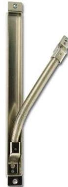
Die Kabelübergänge von CDVI bieten eine sichere Methode für die Kabelverbindung zwischen einem festen und einem beweglichen Punkt (z.B. Türrahmen und Türblatt). Das Kabel wird durch den Spiralschlauch aus Edelstahl geschützt. Der Innendurchmesser des Spiralschlauchs beträgt 9mm und ist somit für die gängigsten mehradrigen Kabel für Türverriegelungen und -steuerungen geeignet.
