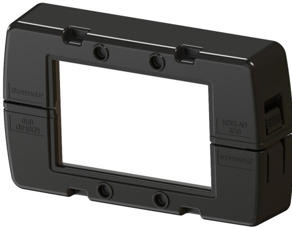
Abdeckhaube für Kabeldurchführung mit TPE Dichtung, Montageart: Rasten, Länge: 106 mm, Breite: 64 mm, IP66, Farbe: Schwarz
