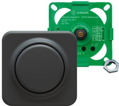
Geeignet zum flackerfreien Dimmen von dimmbaren 12V-LED Lampen, 12V-Glüh- und Halogenlampen, LED Module und Strips mit Begrenzungswiderständen
