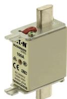
Sicherungseinsatz, Niederspannung, 25 A, AC 690 V, 120 kA, NH000, gL/gG, IEC, Doppelkennmelder, spannungsführende Griffflasche
