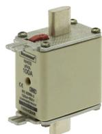
**Sicherungseinsatz, Niederspannung, 100 A, AC 500 V, 120 kA, NH00, gL/gG, IEC, Doppelkennmelder, spannungsführende Griffflasche**
