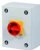
Hauptschalter, T0, 20 A, Aufbau, 2 Baueinheit(en), 3-polig, NOT-AUS-Funktion, mit rotem Drehgriff und gelbem Sperrkranz, abschließbar in 0-Stellung, im Stahlgehäuse
