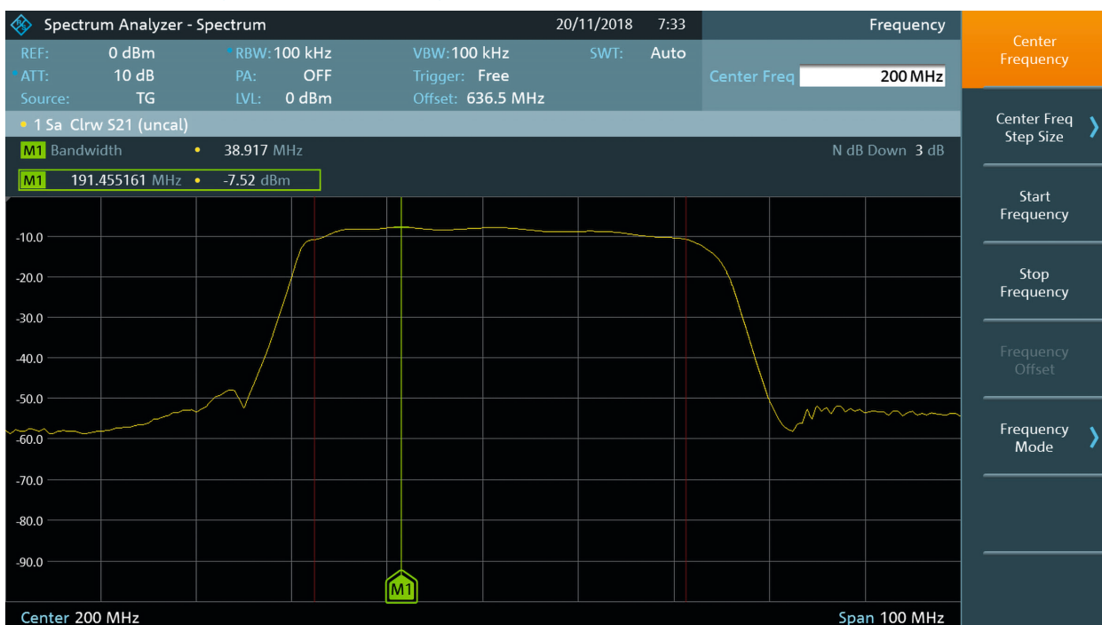
R&S®FPC1500: Der Mitlaufgenerator analysiert eine Signalkette mit Mischern, Filtern und Verstärkern
