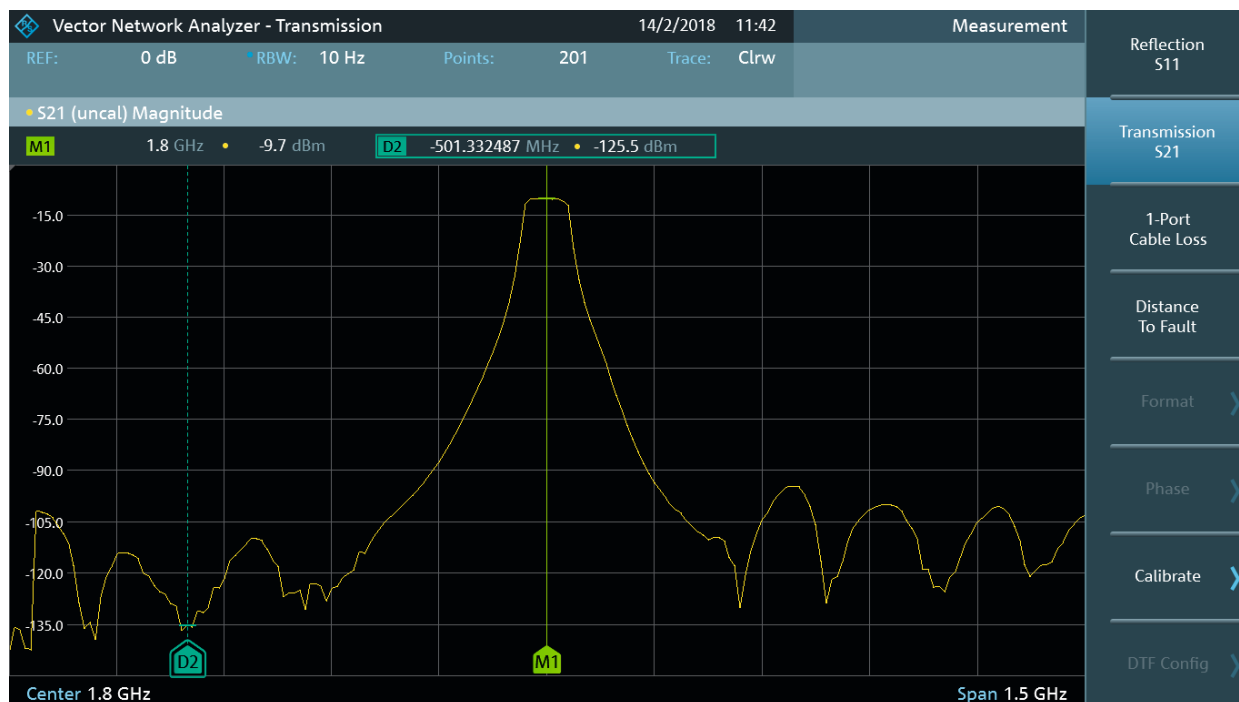
R&S®FPC1500 Skalare S_{21} -Übertragungsmessung mit der R&S®FPC-K42 Option
