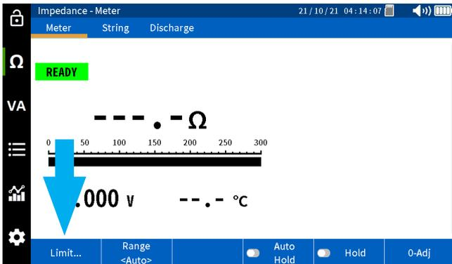
Auf diesem Bildschirm können Sie eine Warn- und Alarmgrenze für den Impedanzwert und eine untere Spannungsgrenze programmieren. Dies ist ein optionaler Schritt. Wählen Sie abschließend „OK“ aus.
