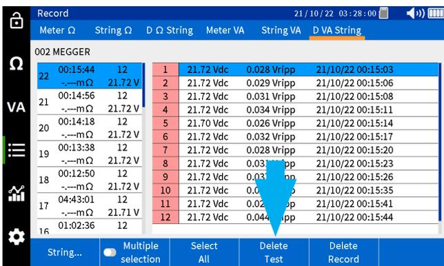
Um eine einzelne Aufzeichnung zu löschen, wählen Sie sie in der rechten Spalte aus und dann die Option „Delete Record“ (Aufzeichnung löschen).
