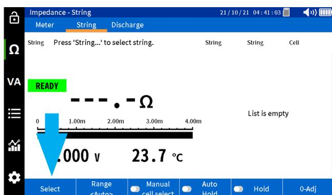
Wählen Sie den gewünschte Strang aus. Wählen Sie „New Test“ (Neue Prüfung), um eine neue Prüfung für den ausgewählten Strang zu starten.
