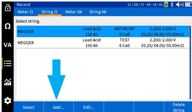
Daraufhin wird der Bildschirm „String Configuration“ (Strangkonfiguration) geöffnet.
