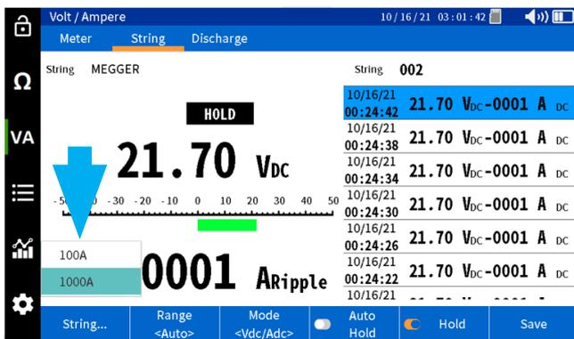
Führen Sie die Messung der ersten Zelle durch. Die Gleichspannung und der Gleichstrom werden mit einem Datum- und Zeitstempel gespeichert.
