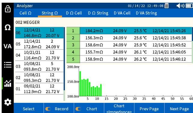
Wählen Sie „Chart“ (Diagramm), um den Parameter zu ändern, für den ein Verlauf erstellt wird.
