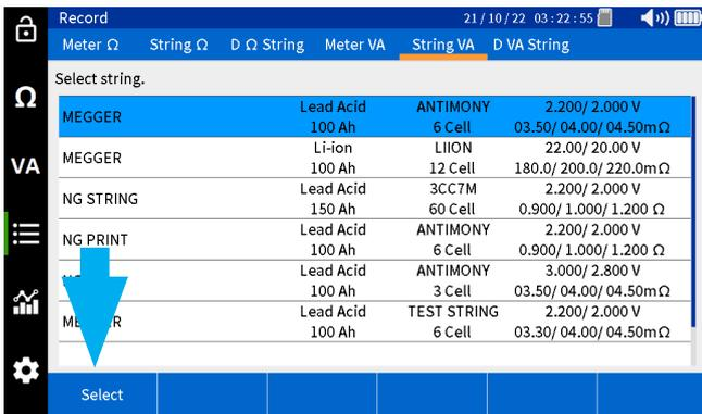
Alle aufgezeichneten Werte werden mit einem Datums- und Zeitstempel angezeigt.
