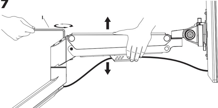
Um den Arm bei montiertem Monitor richtig auszubalancieren, stellen Sie die Federspannung mit dem mitgelieferten Innensechskantschlüssel wie folgt ein:
