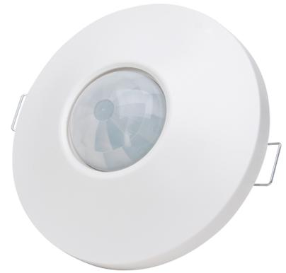
INFRACONTROL Präsenzmelder, Erfassungswinkel 360°, Montage Deckeneinbau, Erfassungsreichweite bis 12 m, Schutzart IP20, Erfassung Infrarot, Master, 1 Kanal zum Schalten von Licht, weiß, 230 VAC, 50 Hz.
