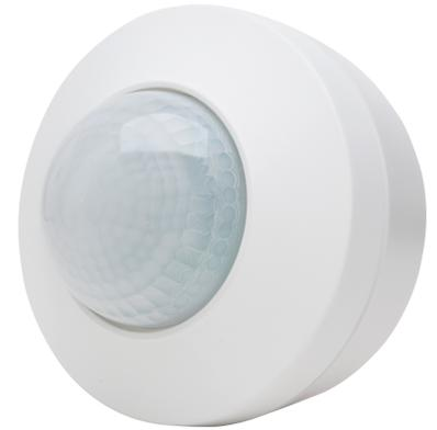
INFRAcontrol Präsenzmelder, Erfassungswinkel 360°, Montage Decke Aufbau, Erfassungsreichweite bis 30 m, Schutzart IP20, Erfassung Infrarot, Master, 1 Kanal zum Schalten von Licht, weiß, 230 VAC, 50 Hz. Glühlampen: 2.000 W Hochvolt-Halogenlampen: 1.000 VA Leuchtstofflampen: 1.000 VA Energiesparlampe: 600 VA LED: 400 W; Einschaltdauer: 10 Sek. - 30 Min., Impulsausgang 1 Sek.; Dämmerungssensor stufenlos 10 - 2000 Lux.; Fernbedienbar (IR-Fernbedienung optional)
