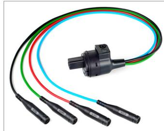
Erd-, Hilfs- und Hilfserder werden über die Bananenbuchsen angeschlossen und so über den Adapter, der auf dem Prüfstecker montiert wird, mit dem Prüfgerät verbunden.
