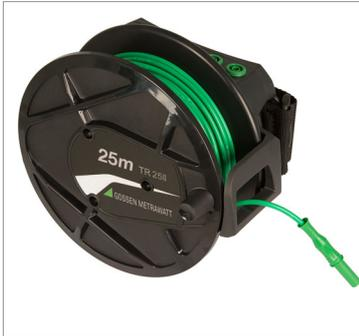
25 m Messleitung, aufgewickelt auf eine Kunststofftrommel. Der Anschluss an das eine Ende der Messleitung ist über zwei in die Trommel integrierte Buchsen möglich. Das andere Ende ist mit einem Bananenstecker ausgerüstet. Der Widerstandsanteil des Kabels kann in der Schalterstellung  $R_{LO}$  kompensiert werden.
