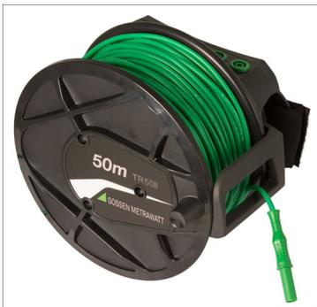
50 m Messleitung, aufgewickelt auf eine Kunststofftrommel. Der Anschluss an das eine Ende der Messleitung ist über zwei in die Trommel integrierte Buchsen möglich. Das andere Ende ist mit einem Bananenstecker ausgerüstet. Der Widerstandsanteil des Kabels kann in der Schalterstellung  $R_{LO}$  kompensiert werden.
