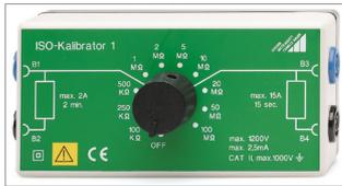
Kalibrieradapter zur schnellen und rationellen Prüfung der Genauigkeit von Messgeräten für Isolationswiderstände und niederohmige Widerstände.
