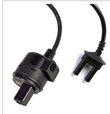
Adapter, der auf dem Prüfstecker montiert wird, zum Anschluss der Generatorzange E-CLIP 2 für die 2-Zangen- oder Erdschleifen-Erdungswiderstandsmessung. Hierdurch wird die 2-Zangen- oder Erdschleifenmessung ermöglicht.
