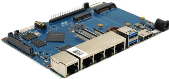
Der R2 Pro ist die nächste Generation der intelligenten Router-Entwicklungsplatine von Banana Pi. Es wird von einem Rockchip RK 3568 4-Kern-Prozessor angetrieben. Das Board verfügt neben 5 GBit Ethernet Ports über zahlreiche weitere Anschlüsse für eine gute Erweiterbarkeit.
