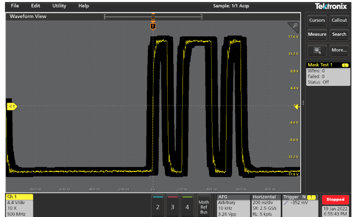
Grenzmaskentest basierend auf einem digitalen Referenzsignal
