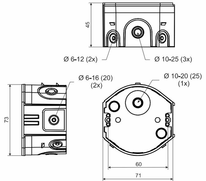
**Produktbeschreibung:** geeignet für Leitungen mit einer Spannung bis 400V und Stromstärke bis max. 16 A
