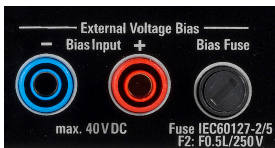
Anschlussmöglichkeit für externe Bias-Spannungen auf der Rückseite
