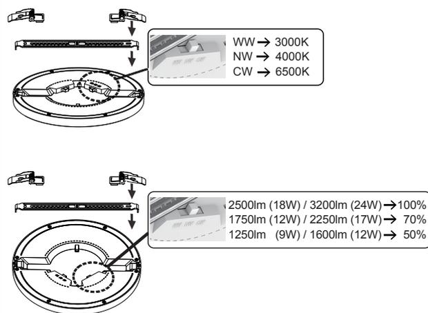
Stellen Sie die gewünschte Farbtemperatur und Helligkeit mit den Schieberegulern auf der Rückseite der Leuchte ein, bevor Sie die Leuchte befestigen.
