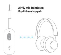
Schalten Sie den AirFly ein, indem Sie den ON/OFF-Schalter nach oben schieben. Der AirFly geht beim ersten Einschalten automatisch in den Kopplungsmodus über, was durch das Blinken des weißen und gelben Lichts angezeigt wird. Fahren Sie mit Schritt 2 fort.
