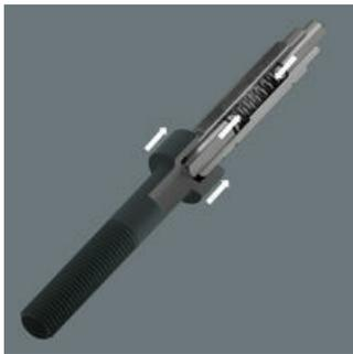
Mit dem 4-in-1 Bit 9506 können vier Größen Innensechskantschrauben (3,0; 4,0; 5,0; 6,0) betätigt werden. Um das jeweils größere Profil zu verwenden, muss beim Schrauben kontinuierlich gegen die Federkraft gedrückt werden, so dass das kleinere Profil versenkt wird und das größere Profil eingesetzt werden kann.
