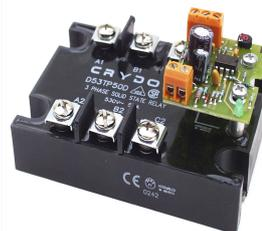
Mit 2064-Set kann die Platine direkt auf die Abdeckung geschraubt werden .
