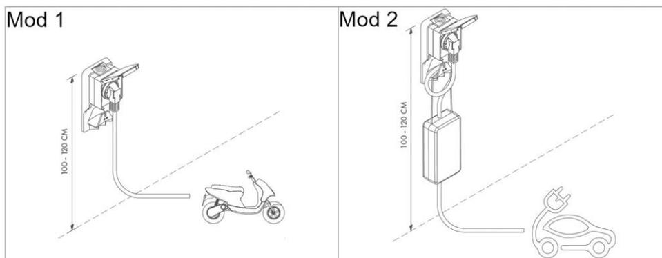
**Zu empfehlen ist die Installation einer 3 x 2,5 mm<sup>2</sup> zusätzlich abgesicherten Leitung von einer Elektrofachkraft vornehmen und prüfen zu lassen**
