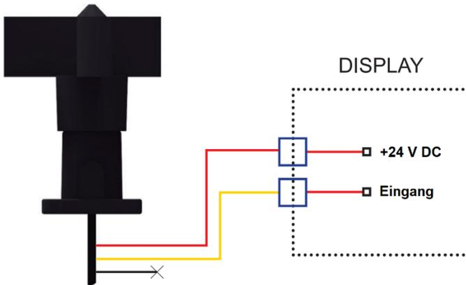
Dreileiteranschluss für den direkten Anschluss an zum Beispiel eine SPS
