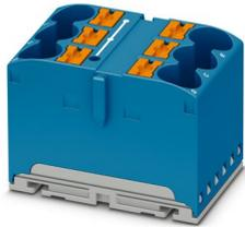
Verteilerblock, intern gebrückt, Nennspannung: 450 V, Nennstrom: 57 A, Anschlussart: Push-in-Anschluss, Bemessungsquerschnitt: 10 mm<sup>2</sup>, Querschnitt: 0,5 mm<sup>2</sup> - 16 mm<sup>2</sup>, Montageart: aufrasten auf Tragschienenadapter, Direktmontage mit Flansch, Fliegend, Farbe: blau
