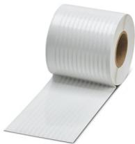
Kennzeichnungstreifen, Rolle, weiß, unbeschriftet, beschriftbar mit: THERMOMARK E.300 (D)/600 (D), THERMOMARK ROLL 2.0, THERMOMARK ROLL, THERMOMARK ROLL X1, THERMOMARK ROLLMASTER 300/600, THERMOMARK X1.2, Montageart: kleben, für Klemmenbreite: 30000 mm, Schriftfeldgröße: 30000 x 3,8 mm, Anzahl der Einzelschilder: 12
