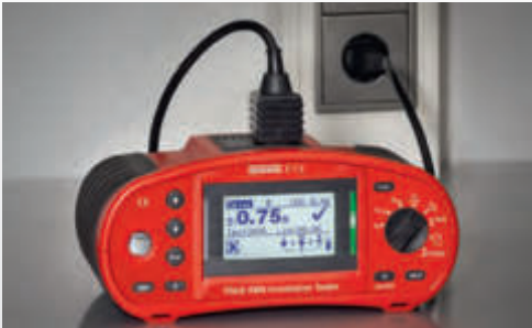
IT 115 bei der Schleifenimpedanzmessung ohne RCD-Auslösung
