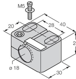
Befestigungsschelle für Gewinderohrsensoren, mit Festanschlag; Werkstoff: PA6
